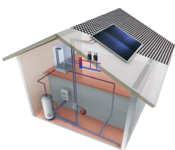
Příklad tradičního zařízení s nádrží pro výrobu TUV, napojeného na kotel externími sestavami pro ovládání zařízení na dvě zóny
